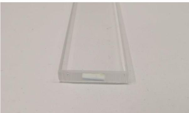
*Abbildung 21 Testausschnitt Borofloatglas*
