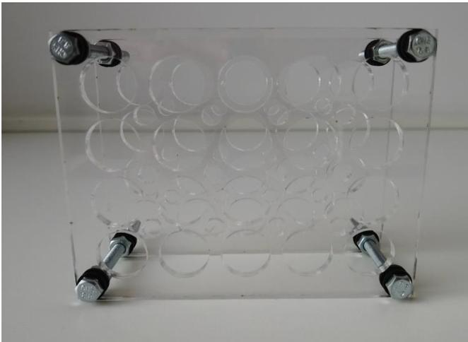
Abbildung 16 Leere E-Magneten Matrix
