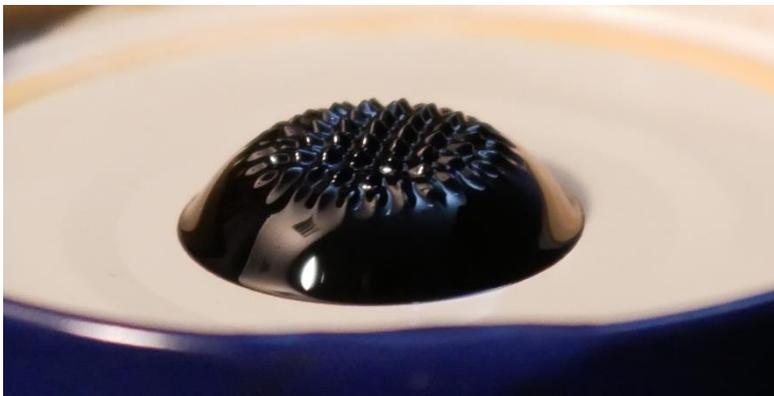
*Abbildung 1 Ferrofluid Tropfen unter der Einwirkung eines Magnetfelds*
