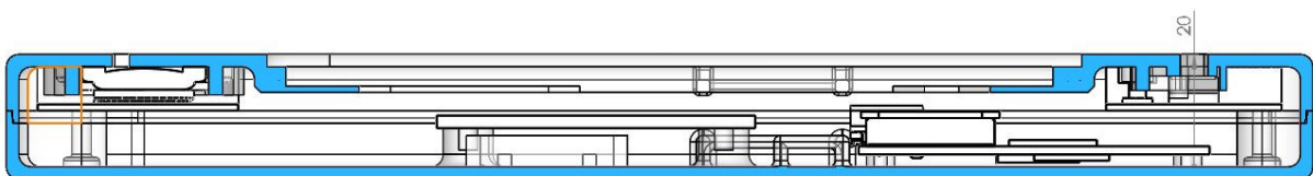
Abbildung 24: Schnittdarstellung der Gesamtbaugruppe mit minimaler Bauhöhe
